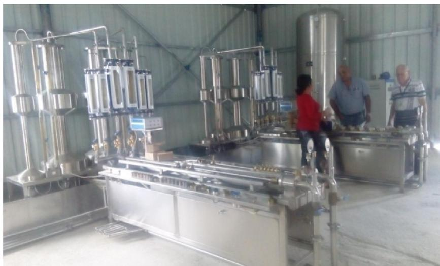
Fig. 4 Banco de calibración con recipientes patrones de capacidad 20 L y 100 L.
