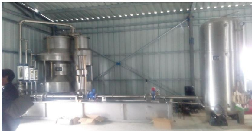
Fig. 3 Banco de calibración con recipientes patrones de capacidad 100 L, 1000 L y 2000 L.
