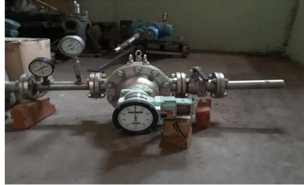
Figs. 5 y 6 Metro contador de agua OVAL ensamblado
