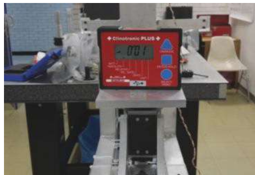
Fig. 11.- Nivel electrónico sobre sujetador de la muestra en dirección del eje y .
