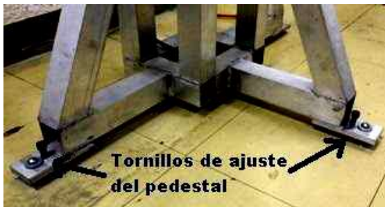
Fig. 6.- Tornillos de ajuste de altura y horizontalidad de la placa de M3
