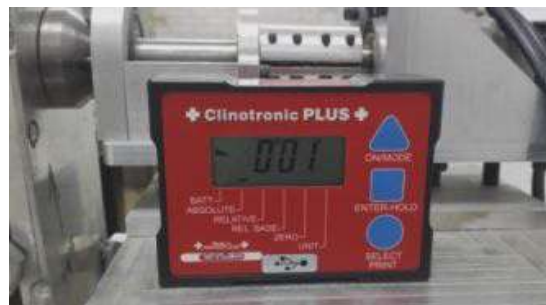
Fig. 7.- Uso del nivel electrónico sobre la placa de M3
