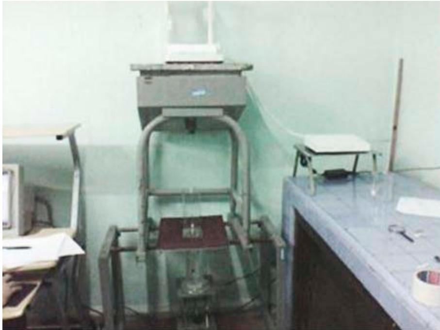
Fig. 10. Estructura de la instalación en el laboratorio para medir con el método de Cuckow.
