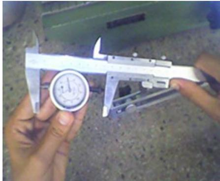
Fig. 3. Medición de la longitud del instrumento de control de cigüeñales y rodamientos en estado libre
