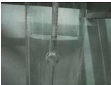
Fig.2. Densímetro de inmersión sumergido en el líquido de referencia.
