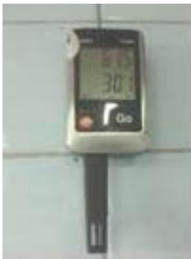
Fig. 6. Termohigrómetro digital.
