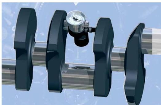
Fig. 2. Flexímetro colocado para la medición de la deflexión del eje de un cigüeñal.
