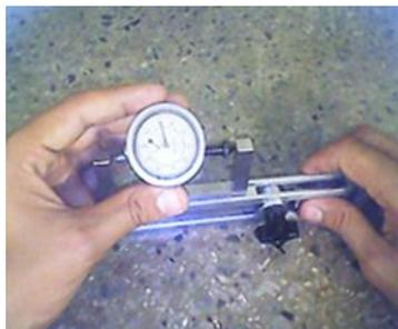
Fig. 4. Colocación del instrumento de control de cigüeñales y rodamientos en el juego de accesorios.
