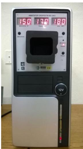
Figura 3. Simulador de velocidad patrón **IC – 24/2**.
