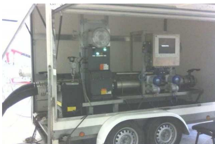
Fig. 24 Patín durante la calibración de los flujómetros
