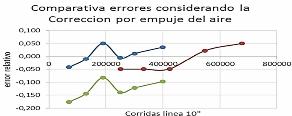
Fig.20 Línea 2 Flujómetro patrón DN 250 corregido por empuje del aire
