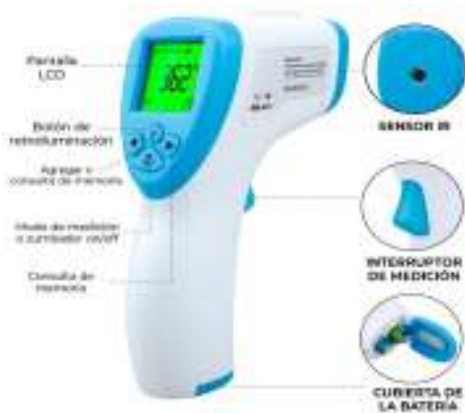
Fig. 9 Partes fundamentales de un termómetro infrarrojo
