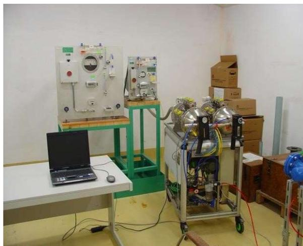
**Fig.16** Estación portátil con toberas críticas
