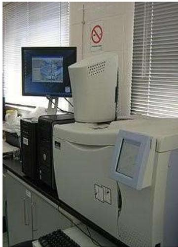
**Fig. 24** Cromatografía de gases
