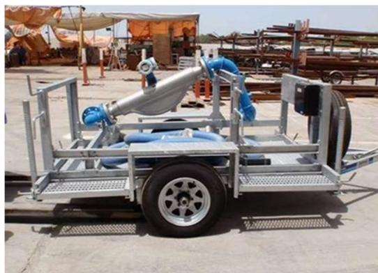
**Fig.28** Metro contador patrón portátil de Coriolis
