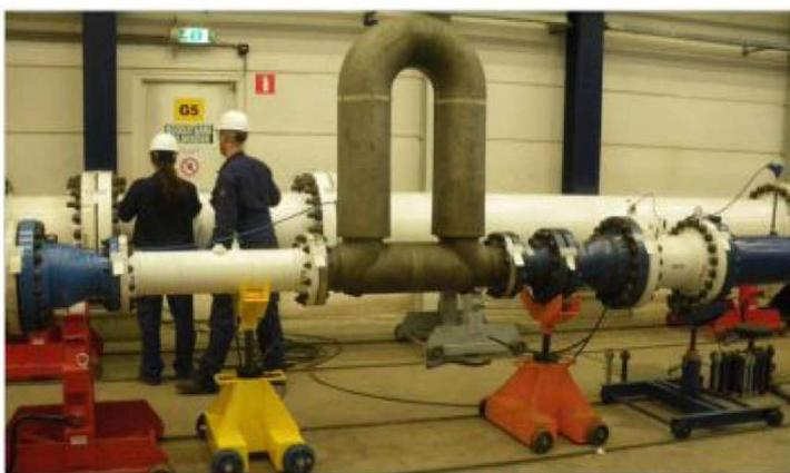
**Fig. 22 y Fig. 23** Instalaciones de calibración con flujómetros Coriolis “Micromotion de Emerson” para gas natural.
