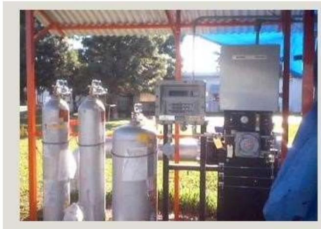
**Fig.25** Gases patrones y cromatografía en campo
