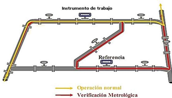
Fig. 20 Esquema tipo “Z”.
