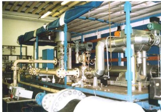
**Fig.14** Probador de pistón con medidor de calibración
